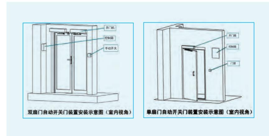
2、自动防鼠板由移动防鼠板、驱动系统、控制器、手动开关和驱鼠器等组成，可接收机器人无线控制或人工控制指令实现防鼠板自动开启或关闭，满足机器人自动进出设备室巡检要求。
